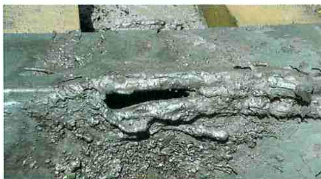
Figura 4.1 - Perfuração de veio ("breakout") da casca que foi estudada.
