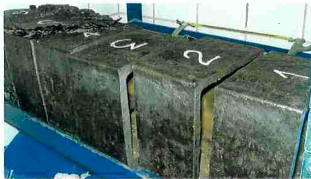
Figura 4.2 - Parte da casca solidificada cortada em diversos pedaços.
