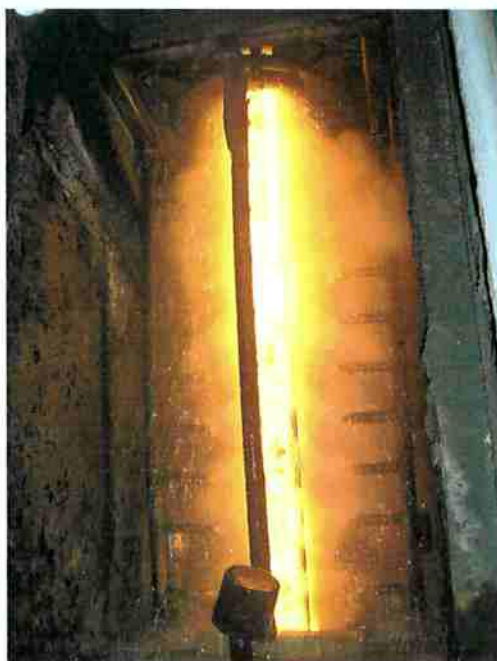
Figura 2.6 - Lingote passando pela câmara de sprays. (foto tirada em visita a usina estudada neste trabalho)
